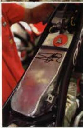
■ ■ ■ El serbatoio della Gas Gas di Raga presentava una notevole modifica. Interamente fatto a mano, coperto da un "cofano" in alluminio, è piccolissimo e contiene circa un litro e mezzo di miscela. La scelta è stata dettata per limitare ulteriormente il peso e allontanare la benzina dal caldo del motore.
